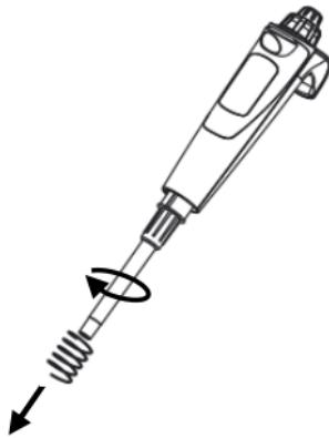
③ 将活塞套上的密封圈压套和 O 形圈分离开。
